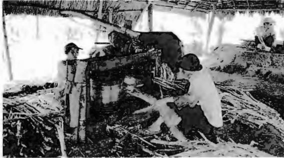
写真一 水牛を使って回転させる圧搾機。2カ所からサトウキビを挟んで、向こう側の人間がそれを受け取る。
